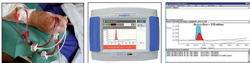
Obr. 7.7 Ultrazvukové diluční měření průtoku krve cévním přístupem (QVA) z nucené recirkulace (zleva doprava – ultrazvuková čidla na „arteriálním“ a „venózním“ krevním setu, vlastní přístroj HD03, zobrazení obou dilučních křivek s vypočtenou hodnotou QVA
